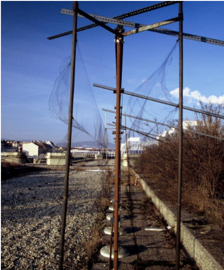
Abb. 2: Versuchsanlage von der Seite um die vor und hinter der Glaswand gespannten Japannetze zu zeigen
