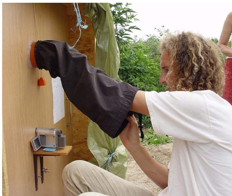
Abbildung 7: An der Rückwand des Versuchstunnels befinden sich Startkanal und Videokamera. Das Foto zeigt wie ein Vogel in die Startröhre gesetzt wird. Der schwarze Schlauch (ein abgeschnittenes Hosenbein) verhindert Lichteinfall von der rückwärtigen Seite.
