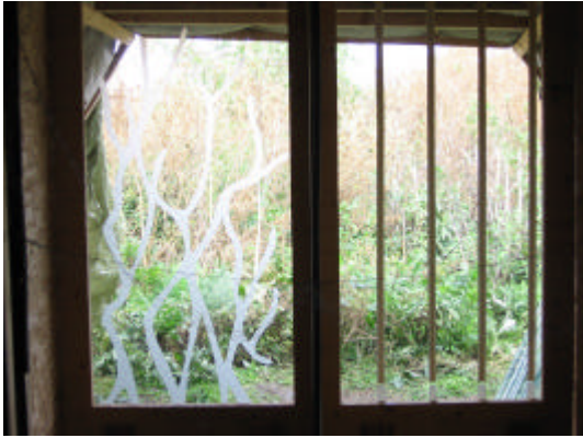
Abbildung 3: Wirksame Markierungen im Jahr 2004 nebeneinander montiert (bei den Versuchen ist jeweils nur eine Versuchsscheibe zusammen mit einer unmarkierten Referenzscheibe montiert): links: „Koralle“, Deckungsgrad ca. 13 %, rechts: „10v“, Deckungsgrad: 16,7 %. Die Markierung „10v“ wurde 2005 zur Überprüfung konstanter Versuchsbedingungen als 2005 als Referenzmarkierung eingesetzt.
