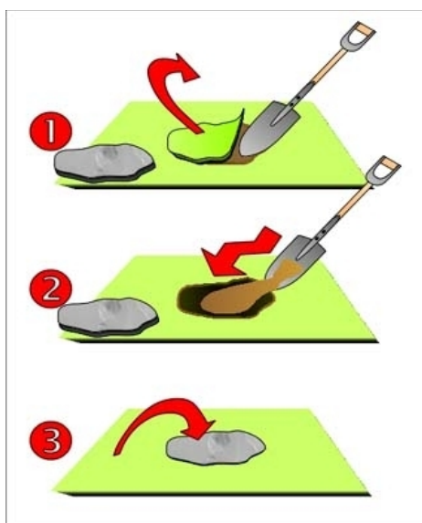
Trittsteine werden in ein flaches Sandbett verlegt
