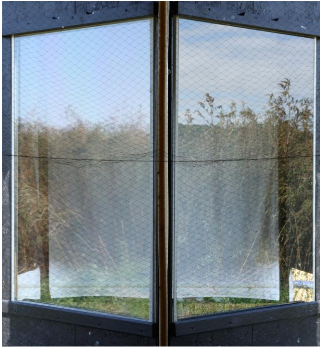
Abbildung 3: Blick aus Perspektive der anfliegenden Vögel auf Prüfscheibe (links) und Referenzscheibe (rechts) im Flugtunnel.
