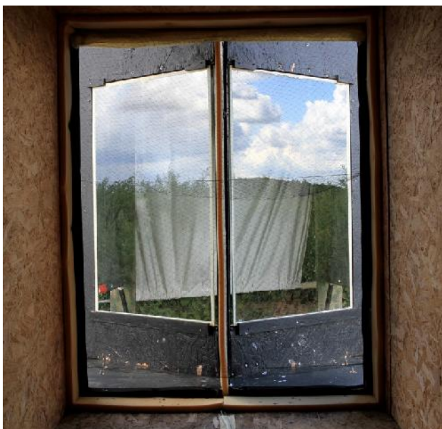
Abbildung 7: Kolbe Streifen. Links beklebte Prüfscheibe, rechts unmarkierte Referenzscheibe. Auch die transparenten Streifen aus birdsticker®-Material sind mit bloßem Auge praktisch nicht zu sehen.
