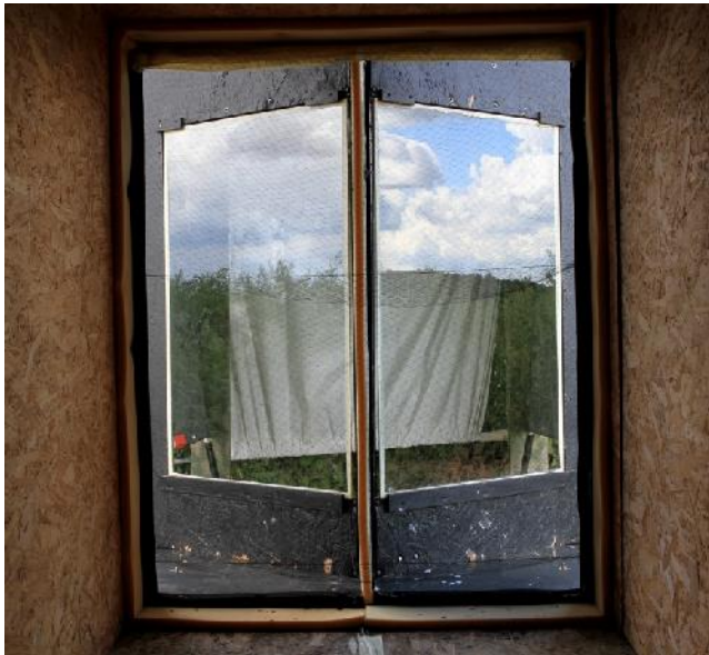
Abbildung 6: birdsticker® (Silhouetten). Links beklebte Prüfscheibe, rechts Referenzscheibe. Die aufgeklebten Silhouetten sind fast nicht zu sehen, sollen aber nach den Erwartungen der Hersteller durch die Reflexion des UV-Lichtes der Umgebung, vor allem des Himmels, für Vögel in abschreckender Weise sichtbar sein. Im Hintergrund der Scheiben befindet sich eine „Kammer“, in der Lichtverhältnisse herrschen, die mit Innenräumen vergleichbar sind. Je nach Lichtsituation kommt es daher zu unterschiedlich kontrastreichen Spiegelungen. Der helle Himmel spiegelt vor dem im Hintergrund montierten Leintuch relativ stark, während der helle Stoff die Spiegelungen der dunkleren Vegetation übertönt.
