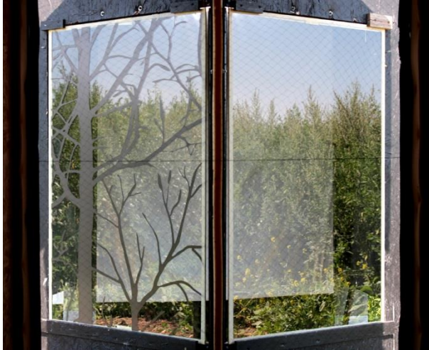
Abb. 6: Prüfscheibe (links) und Referenzscheibe (rechts) aus Perspektive der anfliegenden Vögel im WIN-Versuch. Prüfscheibe: ZOOLEX Astmuster; Digitaldruck auf Position 1, opak, RAL 6014 (gelboliv). Bei auf den Scheiben sichtbarer Vegetation und Himmel handelt es sich um Spiegelungen. Aus dem Scheibenhintergrund erkennt man ein weißes Leinentuch als Rückseite der Kammer hinter den Prüfscheiben.
