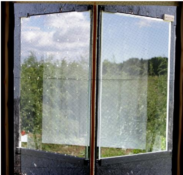
Abbildung 1: Prüfkandidat „SEEN spiegelnd“ (links) und unmarkierte Floatglas Referenzscheibe (rechts) aus der Perspektive eines heranfliegenden Vogels im Flugtunnel.
